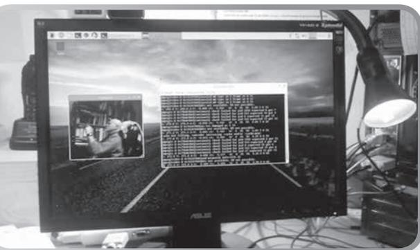
Figura 5 – Imagem DATV no PI receptor vinda do PI emissor com a janela de comandos ao lado
