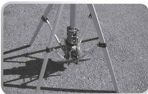
[Figura 6 – O Rotor dos azimutes fica preso entre as hastes do suporte.]
