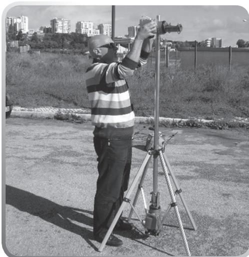
[Figura 4 – Colocação do rotor das elevações.]
