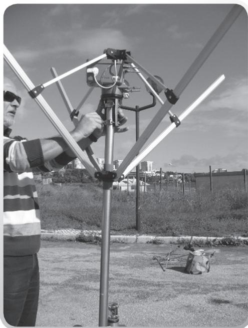
[Figura 3 – Colocando o rotor dos azimutes sem qualquer orientação.]
