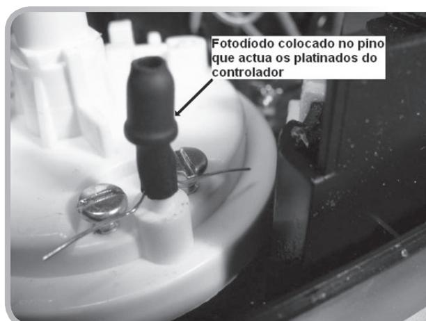
O ângulo de paragem do fotodíodo representa o meio de um sector com +- 3 graus para cada lado. Por isso, a antena permanecerá parada enquanto os valores dos azimutes e das elevações permanecerem dentro dos sectores respectivos.
